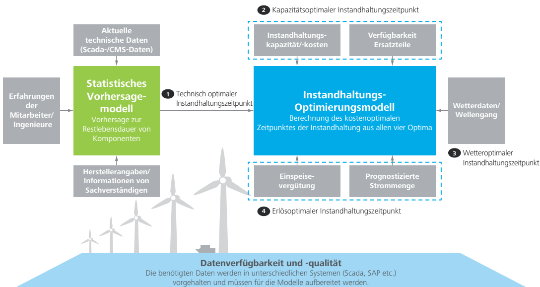
Abb. 3 – Predictive Maintenance – Optimierung der Instandhaltungskosten und Ausfallzeiten
