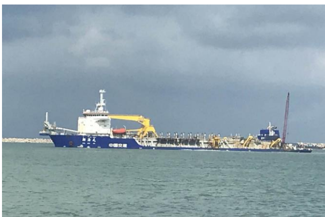
图为正在关丹深水港工作中的中国交建耙吸船 - 新海虎号
