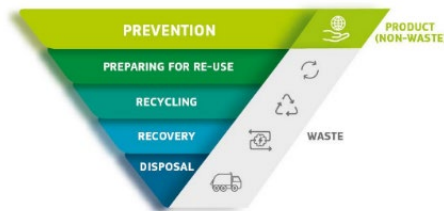
รูปที่ 2: ลำดับชั้นการจัดการของเสีย (Waste Hierarchy) ที่มา: European Commission (2023)
